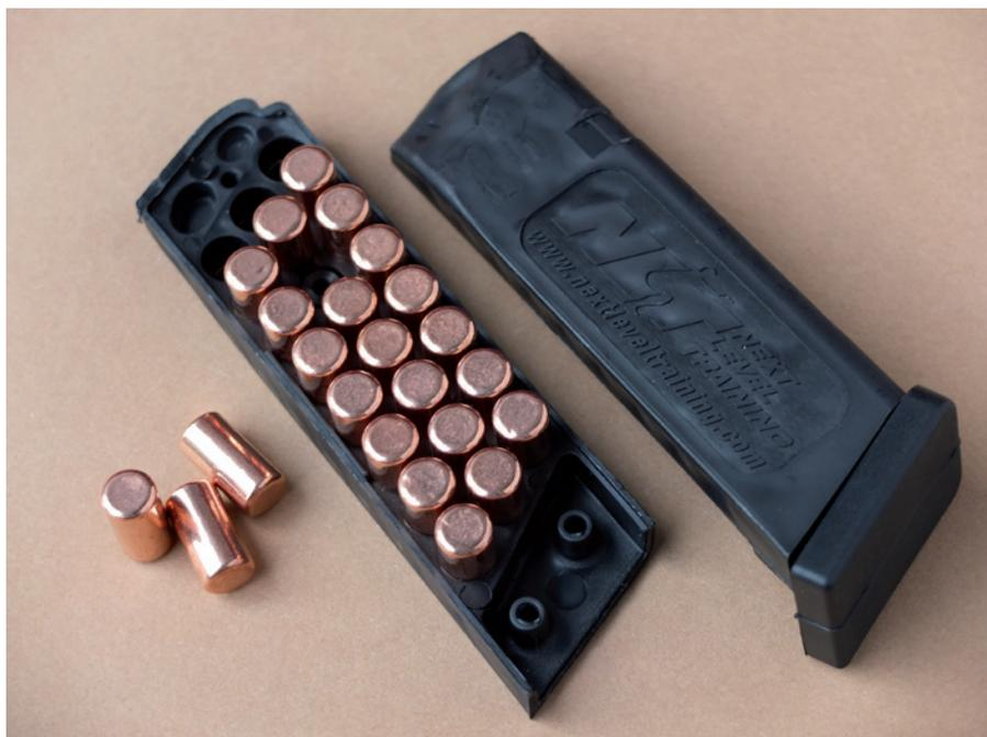
Das für 25 Euro separat erhältliche SIRT-Magazin passt auch in die Glock und kann in idealer Weise für den Störungsbeseitigungsdrill (Tap-Rack-Bang) benutzt werden. Neben dem realen Magazingewicht bietet es den Vorteil, dass der Schlitten nach dem manuellen Repetieren durch die Attrappe nicht gefangen wird.
