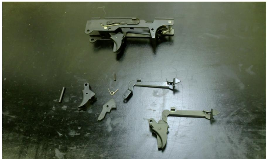
Multifunktionseinheit und darunter befindliche Abzugseinheit montiert und in Einzelteilen.
