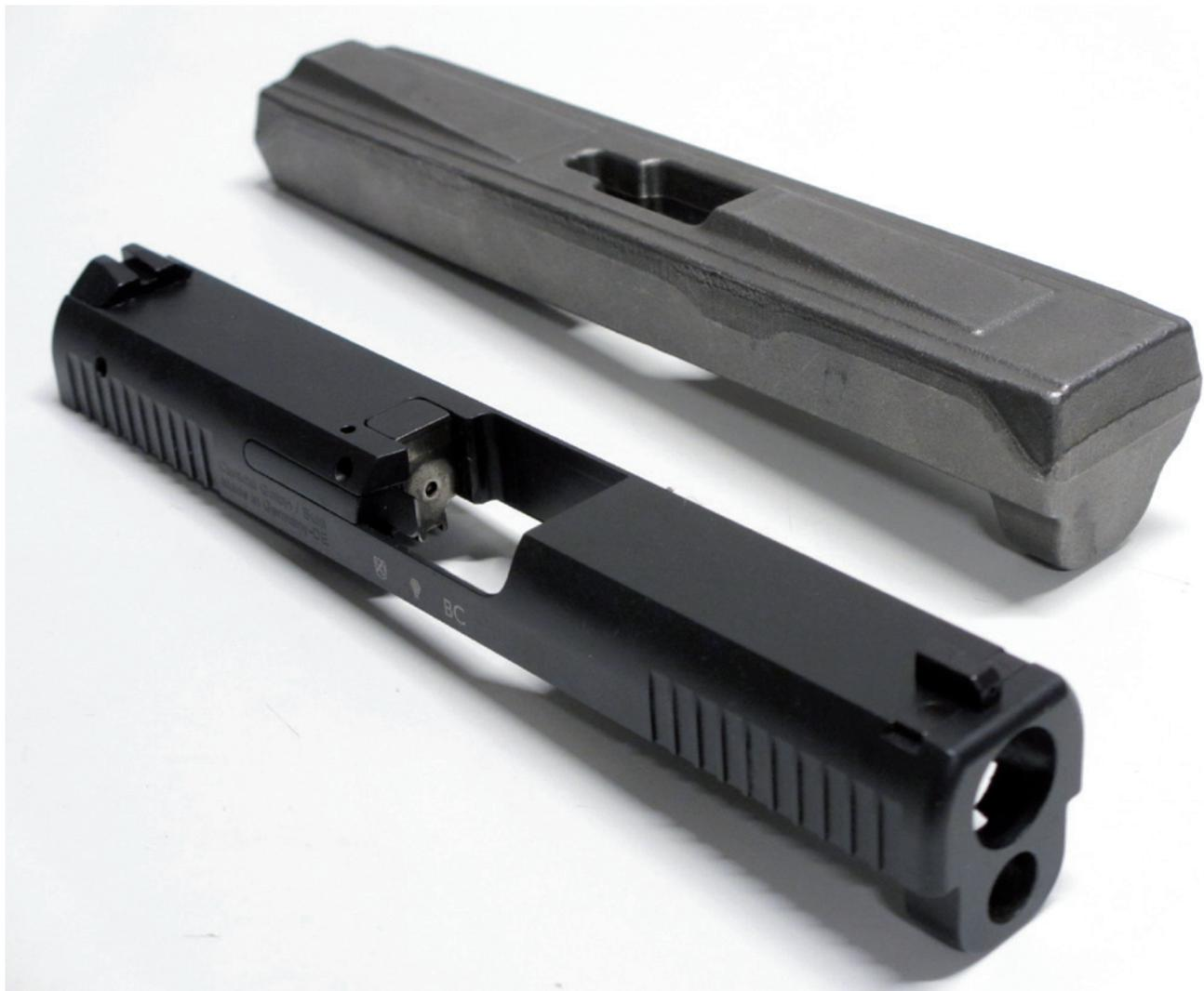
Schlittenrohling und Fertigprodukt im Vergleich.
