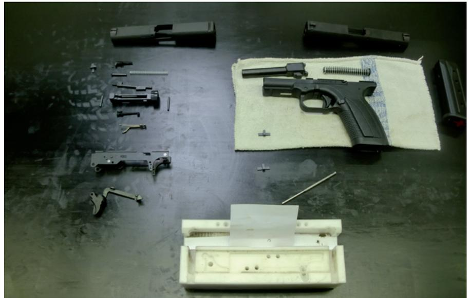
Die aus 28 Teilen bestehenden Pistolen lassen sich ohne Werkzeug in fünf Baugruppen zerlegen. Schlagbolzen- und Abzugseinheit sind einzelne Komponenten in offener Bauweise.
