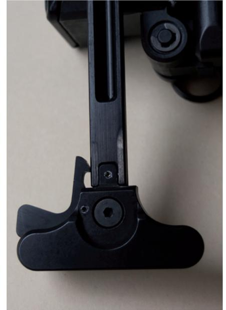
Der Durchladehebel im AR 15 Style wird oberhalb der Pistole im Basisgehäuse geführt. Er ist von Rechts- und Linkshändern bedienbar.
