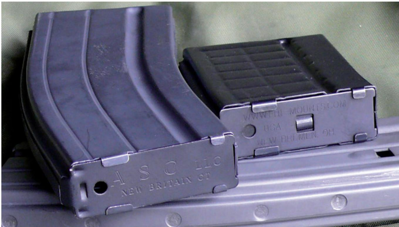
Die .223-Rem-Magazinkörper können verwendet werden, der Zuführer allerdings bedarf einer Modifikation. Derzeit sind nur Magazine von zwei Herstellern lieferbar: 26 Schuss-Magazine von ASC und 10 Schuss-Magazine von Pri-Mounts.com. Der Endverbraucherpreis ist entsprechend hoch.
