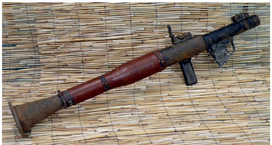
Auch dieses Abschussrohr einer reaktiven Panzerbüchse RPG-7 hat schon bessere Tage gesehen. Es fehlt die optische Visiereinrichtung. Das mechanische Eisensvisier ist nicht mehr vollständig aufklappbar und auch das Griffstück mit Abzugseinrichtung musste der hohen Luftfeuchte Tribut zollen.
