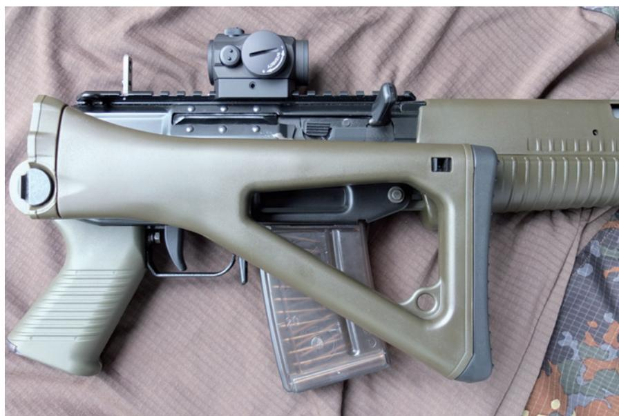
Durch die niedrige Visierlinie wird im Anschlag eine optimale Wangenaufgabe (Cheek Weld) erreicht. Der Ladehebel kann noch bequem bedient werden.
