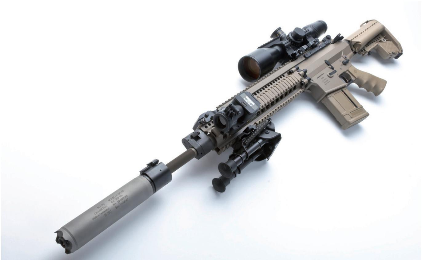
Pünktlich zur IWA präsentierte die Oberland Defence GmbH einen neuen Selbstlader im Kaliber 7,62x51mm. Der Gasdrucklader basiert auf dem Funktionsprinzip des AR-15 bzw. des AR-10. Das bedeutet er besitzt eine Gasabnahme im Lauf und arbeitet mit dem direct impingement System. Hierbei werden die Pulvergase über ein Gasrohr unmittelbar in den Verschlussträger geleitet, wo sie ihre Arbeit verrichten und den Nachladevorgang einleiten.
