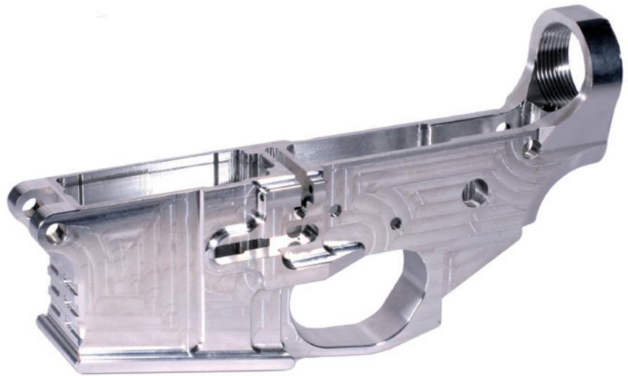
Der Lower Receiver unmittelbar nach dem CNC-Fräsen. Im Anschluss wird das Bauteil trowalisiert, glasperlgestrahlt und abschließend mattschwarz hardeloxiert.
