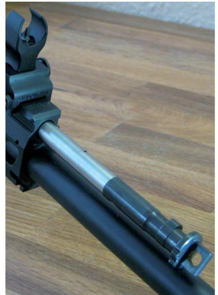
Das Gasgestänge kann dann nach vorn aus der Waffe entnommen werden. Ein Falscheinbau ist aufgrund der Konstruktion ausgeschlossen.
