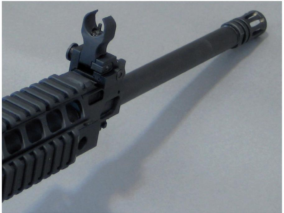
Die Visierung wurde bei der Testwaffe ausgetauscht. Wir werden ein Samson Klappkorn aus Aluminium verwenden, welches weniger hitzeempfindlich ist und daher auf der Gasentnahme montiert werden kann. Die Visierlinienlänge wächst somit um etwa 5 cm.
