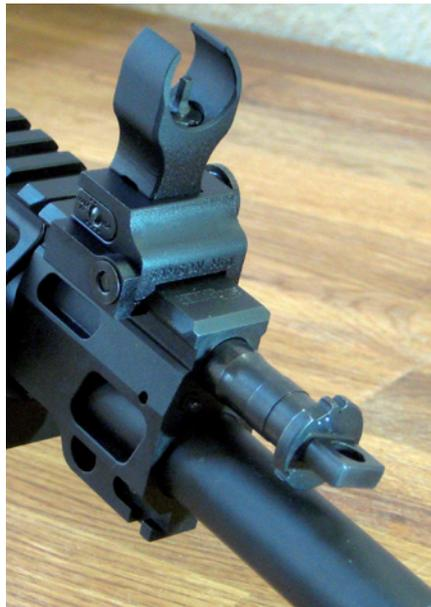
Zum Zerlegen wird es im Uhrzeiger sinn (bei Draufsicht) gedreht, bis es entriegelt.
