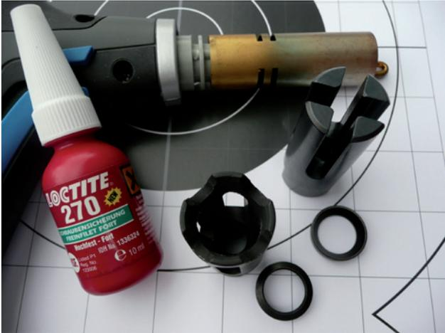
Der hochfeste Kleber Loctite 270 neben dem MFD Phantom und OA-TEX. Darunter die Ausgleichsringe, die eine exakte Ausrichtung in einer bestimmten Position ermöglichen
